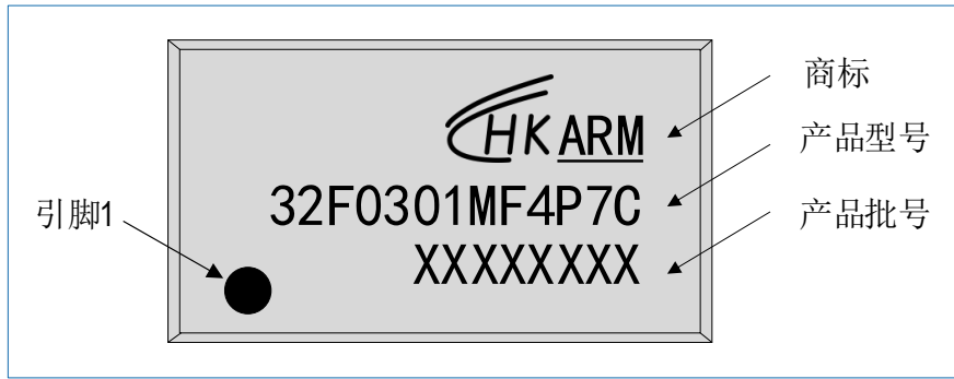
图 7-8 TSSOP20 HK32F0301MF4P7C 丝印示例
